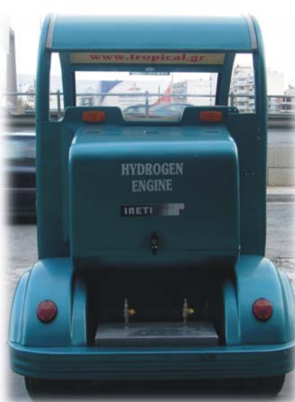
Το αυτοκίνητο υδρογόνου της Tropical AEBE από την πίσω πλευρά όπου διακρίνεται το κουτί που είναι τοποθετημένος ο κινητήρας υδρογόνου
