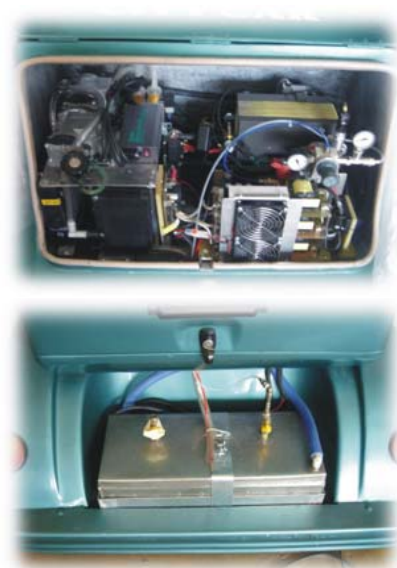
Στις φωτογραφίες πάνω φαίνεται ο κινητήρας υδρογόνου και στην κάτω φωτογραφία διακρίνουμε το δοχείο υδρογόνου με μεταλλικά υδρίδια.
